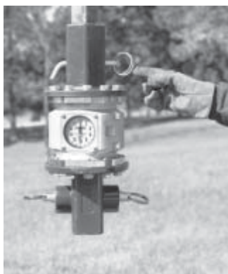
7.1.attēls Iekārta ar, kuru kontrolē montējamā skrūvpāļa kāta griezes momenta lielumu
