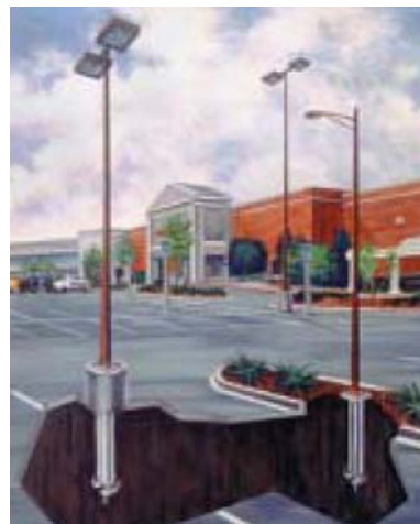
8.4. attēls Attēlā redzami divu veidu skrūvpāļu pamati zem apgaismes sistēmas konstrukcijām
